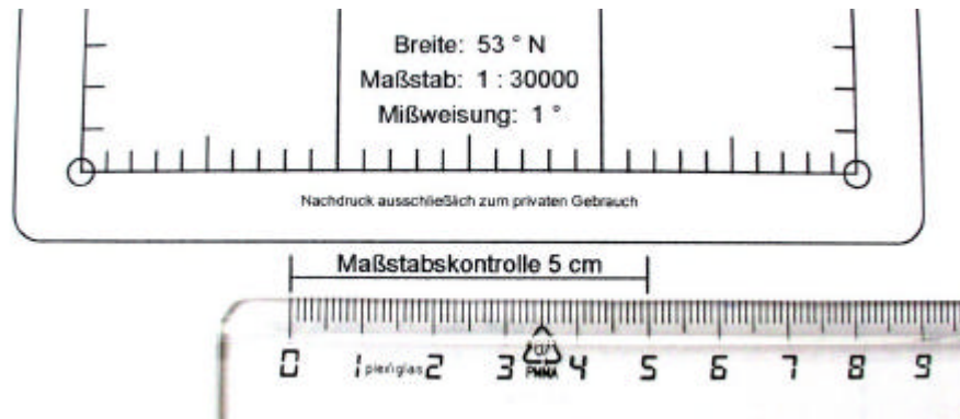
Bild 4: Überprüfen des Ausdrucks mit einem Lineal. Die Werte (hier 5cm auf der „Maßstabskontrolle“ und auf dem Lineal) müssen übereinstimmen!
